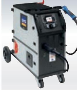
Synergetisches, einphasiges MIG/MAG-Schweißgerät mit 200 A, das speziell für den Karosseriebauer entwickelt wurde. Es ist mit einem sehr intuitiven farbigen Bedienfeld ausgestattet und schweißt Stahl und Aluminium auch bei geringen Stärken perfekt zusammen. Seine Synergien umfassen auch Schweißlöten mit CuSi3- und CuAl8-Drähten.
