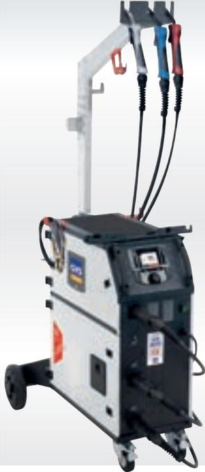
Synergisches, einphasiges MIG/MAG-Schweißgerät mit 200 A und drei integrierten Drahtvorschüben, welches speziell für den Karosseriebauer entwickelt wurde. Es ist mit einem sehr intuitiven farbigen Bedienfeld ausgestattet und schweißt Stahl und Aluminium auch bei geringen Blechstärken perfekt zusammen. Seine Synergien umfassen auch MIG-Löten mit CuSi3- und CuAl8-Drähten.
