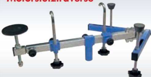
Die universelle Motorstütztraverse fängt den Motor sicher von unten ab sobald die seitlichen Motorlager demontiert sind. Die übliche Motorbrücke wird nicht mehr benötigt. Bei Arbeiten an Zahnriemen, Wasserpumpe oder Nebenantrieb ist nun ein freier Zugang von oben möglich. Inkl. einer Aufnahme für handelsübliche Getriebeheber. Damit kann die Traverse auch von einer Person sehr einfach montiert werden.
