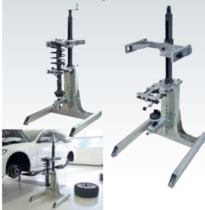
Universell passend für nahezu alle McPherson Federbeine am Markt. Besonders passend bei rechts- oder linkssteigenden Federn, konischen Federn, exzentrischen Federn, Federn mit geringer Windungsanzahl, Federn mit starker oder unterschiedlicher Federsteigung, Federbeine mit Zuganschlagfeder sowie bei Federbeinen mit elektronischer Regelung und Sensorik.
