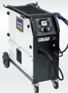
Dreiphasiges Multi-Prozess-Inverter-Schweißgerät. Seine Spitzentechnik sorgt für hervorragende Lichtbogeneigenschaften bei anspruchsvollen MIG/MAG-Anwendungen. Die eingebauten Synergien erleichtern die Einstellungen erheblich und verringern die Spritzer beim Schweißen. Seine beleuchtete und leicht zugängliche Benutzeroberfläche bietet eine präzise Steuerung der Schweißparameter, um eine perfekte Nahtqualität zu gewährleisten.
