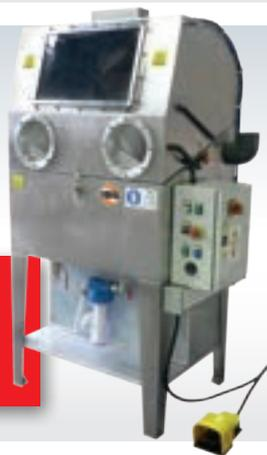
**Teilereinigungsgerät Typ WD-100**
